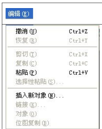
编辑菜单中存放【撤销】、【恢复】、【剪切】、【复制】、【粘贴】和【打印】命令，这些命令的功能与操作在标准工具栏都对应有关快捷图标，请参阅标准工具栏的介绍。
