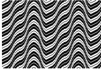
图 5-35B 曲线斜纹组织效果
