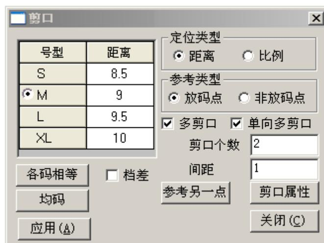
1. 【定位类型】选中距离时，加剪口以距离定位，数据为所加剪口到参照点（亮星点）的长度；选中比例时，加剪口以比例定位，比例为剪口到亮星点的长度与选中线长度的比例；
