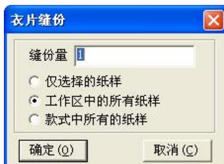
2. **多段边线上加（修改）相同缝份量：**用该工具同时框选或单独框选加相同缝份的线段，击右键弹出【加缝份】对话框，输入缝份量，选择适当的切角，确定即可；
