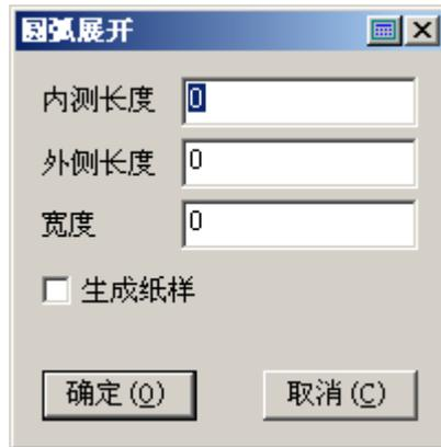
用该工具在空白处单击，在弹出的【圆弧展开】对话框中输入需要的数值，点击确定即可。
