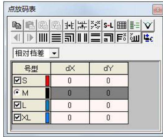
29. 用选择纸样控制点工具框选放码量相同的放码点，如前后幅侧缝放码点，在点放码表的 DX 中除基码外的任一个码中输入 1，单击 X 相等；
