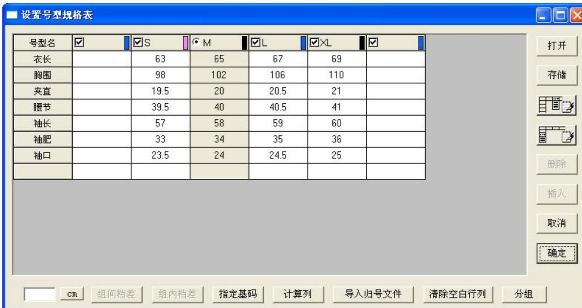
【打开】用来打开已存储的号型规格;
