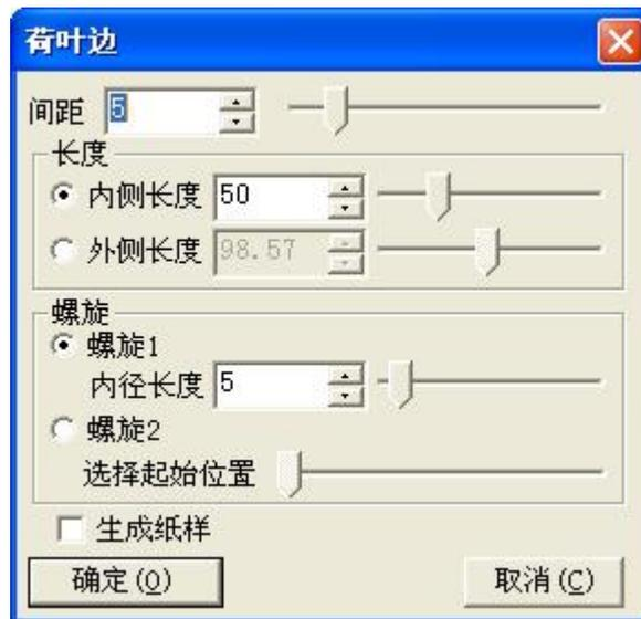
2. 单击或框选所要操作的线后，击右键，弹出【荷叶边】对话框，有 3 种生成荷叶边的方式，选择其中的一种，按确定即可。（螺旋 3 可更改数据）
