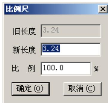
2. 在新长度中输入新的长度或比例中输入合适的比例，确定即可。
