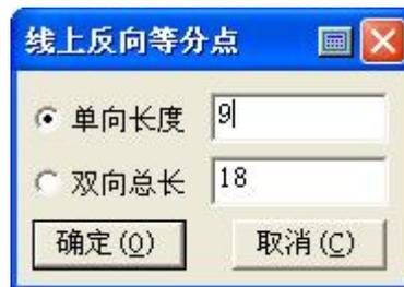
3. 等份线段: 在快捷工具栏等份数中输入份数, 再用左键在线上单击即可。如果在局部线上加等份点或等份拱桥, 单击线的一个端点后, 再在线中单击一下, 再单击另外一端即可。
