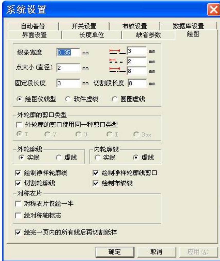
【线条宽度】用于设置喷墨绘图仪的线的宽度;
