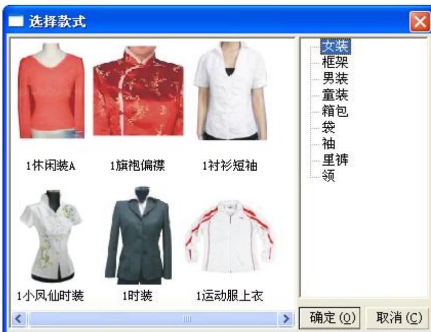
2. 双击所需款式，弹出【自动打版】对话框（上左为示意图，上右为结构图，右下为尺寸规格表），尺寸数据可以根据实际情况修改(也可以单击【尺寸表】后的
