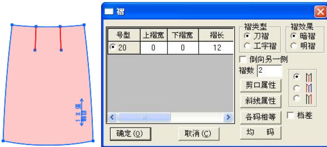
3. 如果需要做通褶，按照步骤 1 的方式选择褶的另外一段所在的边线，击右键弹出褶对话框；
